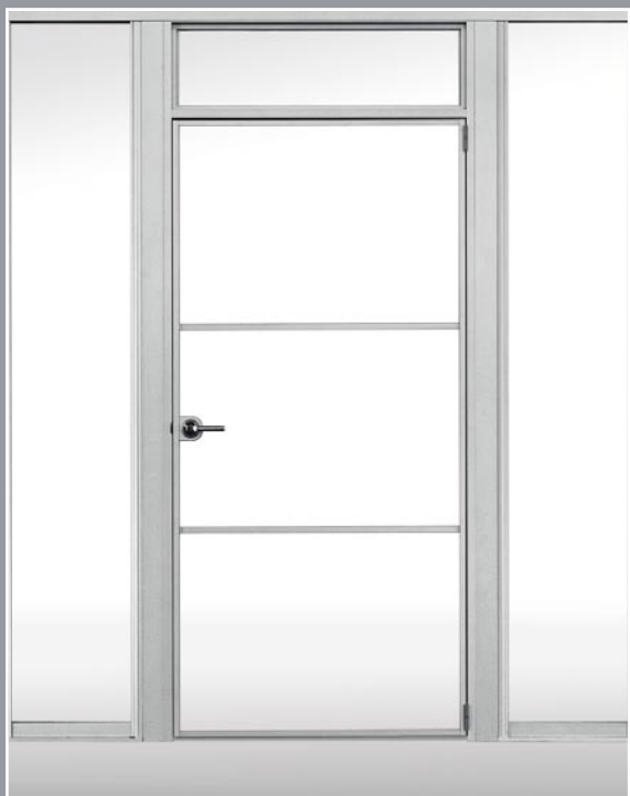
Drzwi uchylne ramowe z podziałem, wypełnienie szyba bezpieczna 6 mm. Pivoting frame doors with division, insert 6 mm safety glass.
